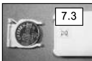
Télécommande remplacement de la pile 3V CR2025
