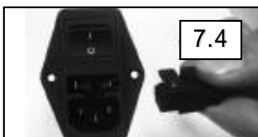
Porte-fusibles de la prise. (2 fusibles 5x20 mm 250V 3,15 AT)
