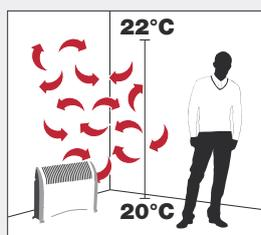
Les lames décalées provoquent des turbulences mélangeant l'air chaud à l'air ambiant
