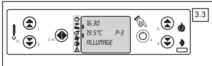
Lorsque les premières flammes apparaissent, sélectionner la puissance P5 (cf § 6.2). Après 20 minutes, si nécessaire, ajuster le débit de granulés (cf § 9.8.2).
