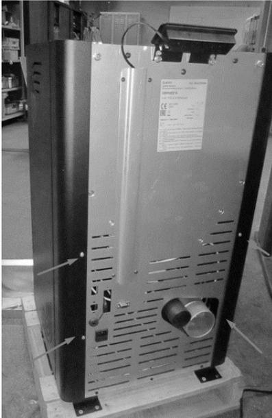
Déviser les 2 vis de chaque côté à l'arrière de l'appareil
