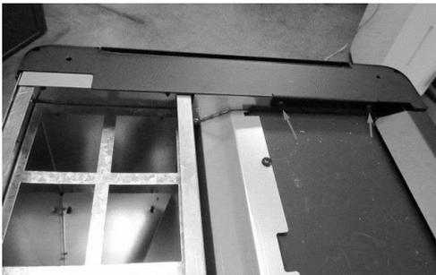
Retirer les 2 vis de fixation de chaque côté se situant sur le dessus de l'appareil
