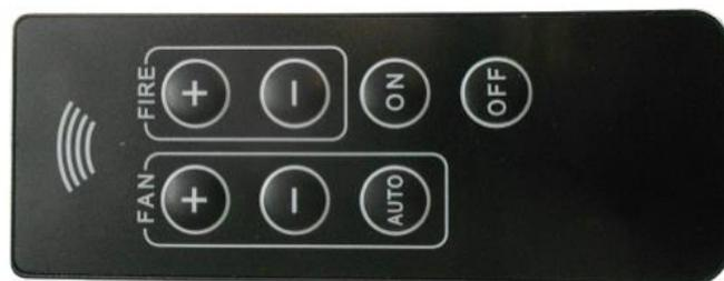
La télécommande permet de mettre en marche et d'arrêter le poêle via une information infrarouge, et aussi d'augmenter ou de diminuer le débit d'air du ventilateur de convection et le niveau de puissance de l'appareil.
