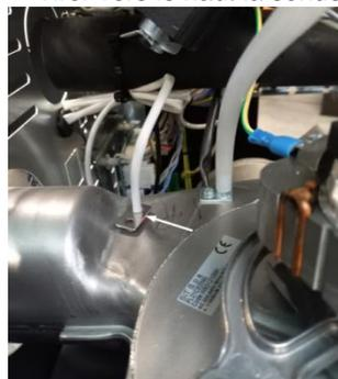
7. Débrancher le câble encodeur
