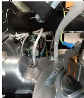
6. Débrancher la sonde des fumées
