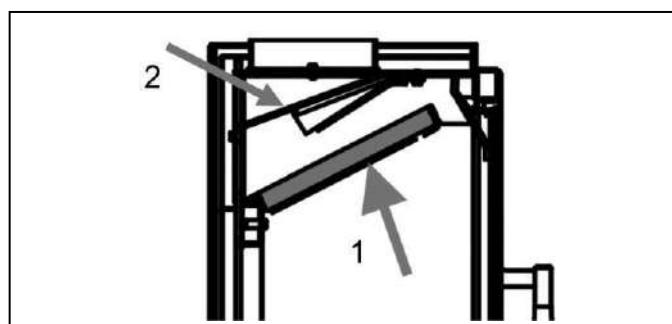
Para desparafusar, retire o defletor de vermiculite (peça 1) e desenrosque o defletor de fumos (peça 2). Para voltar a montar,
