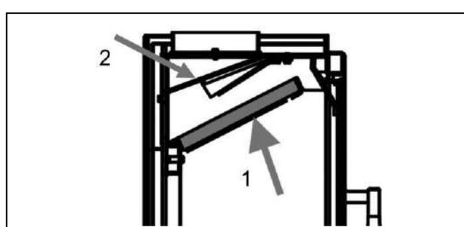
Para el deshollinado, retire el deflector de vermiculita (pieza 1) y desenrosque el deflector de humos (pieza 2). Para volver a montar el aparato una vez deshollinado y limpio, proceda en sentido inverso.
