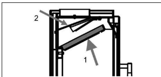
Per la pulizia della fuliggine, rimuovere il deflettore di vermiculite (elemento 1) e svitare il deflettore dei fumi (elemento 2). Per
