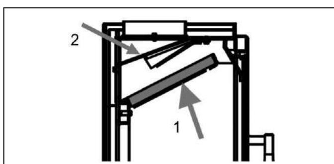
Lors du ramonage enlever le déflecteur des fumées vermiculite (Pièce 1) et dévisser le déflecteur des fumées (Pièce 2). Après ramonage et nettoyage de l'appareil remonter dans le sens inverse
