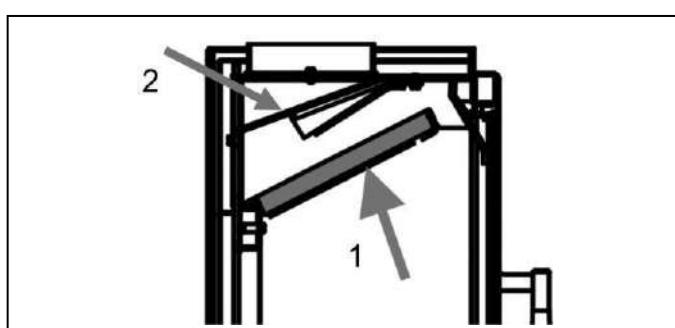
Per la pulizia della fuliggine, rimuovere il deflettore di vermiculite (elemento 1) e svitare il deflettore dei fumi (elemento 2). Per
