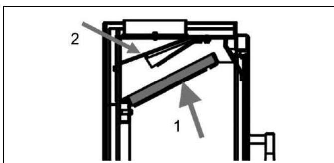
Entfernen Sie zur Russentfernung den Vermiculit-Deflektor (Teil 1) und schrauben Sie den Rauchdeflektor (Teil 2) ab. Um die Teile
