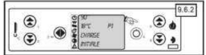
Le chargement de la vis sans fin s'arrête automatiquement après 90 s, mais il est préférable d'arrêter le chargement lorsque les granulés tombent dans le brûleur (appuyer sur "4"). Retirer les granulés du brûleur. Le poêle peut être allumé (§ 6.2.1).
