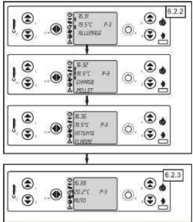
Les commandes automatiques ou saisies par l'utilisateur (puissance, température) sont actives (fig. 6.2.3) lorsque la phase d'allumage est terminée (15 min. environ).
