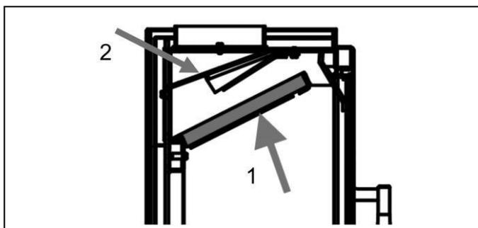
Lors du ramonage enlever le déflecteur des fumées vermiculite ( Pièce 1) et dévisser le déflecteur des fumées ( Pièce 2). Après ramonage et nettoyage de l'appareil remonter dans le sens inverse
