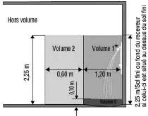
\* Dans le cas où la douche comporte une paroi jointive au sol et au mur, la distance d'1,20 m ne doit plus être prise en compte. C'est alors la façade de la paroi qui délimite le volume 1.
