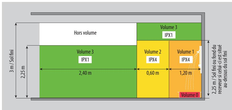
Dans le cas où la douche comporte une paroi jointive au sol et au mur, la distance d'1,20 m ne doit plus être prise en compte. C'est alors la façade de la paroi qui délimite le volume 1.
